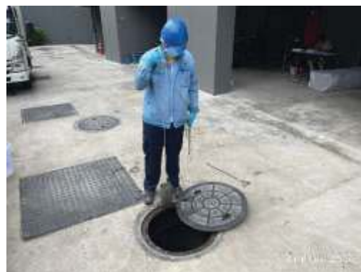
จุลรวมรวมน้ำเสียเข้าระบบบำบัดน้ำเสีย ภาพที่ 3.5.3-1 การเก็บตัวอย่างคุณภาพน้ำทิ้ง
